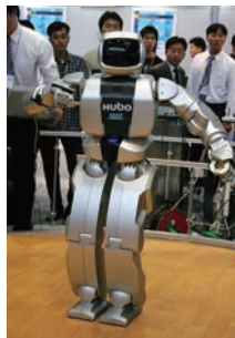
한국 최초의, 두 발로 걸을 수 있는 인간형 로봇 후보(HUBO) <출처: 두산백과사전>
